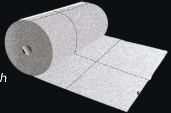
*Die Rollen sind in verschiedenen Dicken und Formaten erhältlich und bieten jeweils unterschiedliche Absorptionskapazität, die direkt proportional zur Dicke ist.*
